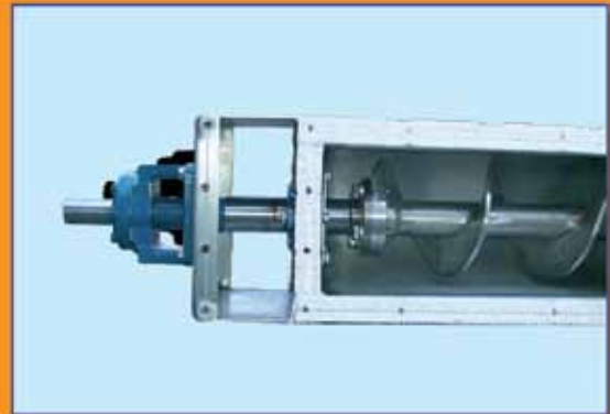
Spacer for heat insulation Abstandhalter zur Wärmeisolation Entretoise d'isolation Distanziale d'isolamento
